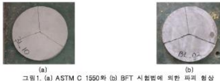
그림 1. (a) ASTM C 1550와 (b) BFT 시험법에 의한 파괴 형상
